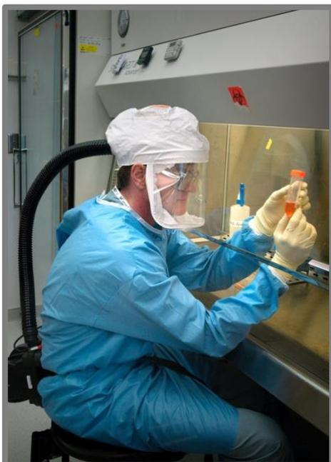
**(c) Cabines de Segurança Biológica – CSB (Capelas):** As CSB constituem o principal meio de contenção e são utilizadas para proteger o profissional e o ambiente laboratorial dos aerossóis ou borrifos infectantes, gerados a partir de procedimentos como centrifugação,
